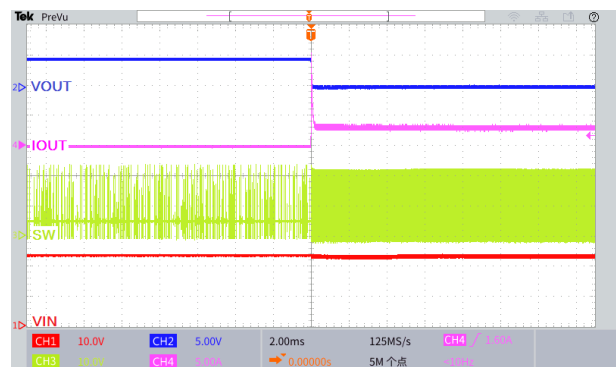
图 29.输出短路波形
