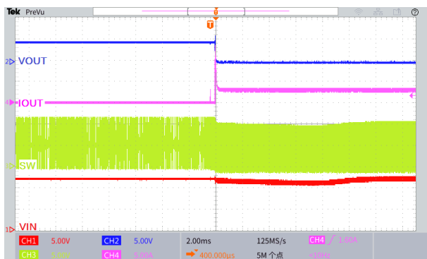
图 28.输出短路波形
