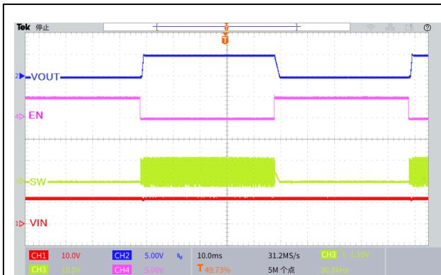
图 28.EN 引脚开关机波形
