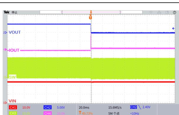
图 23.输出短路波形
