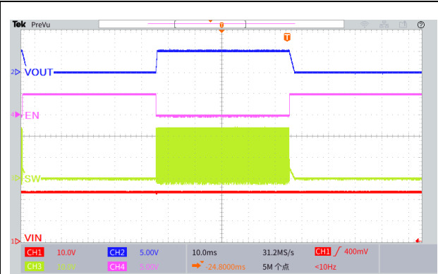
图 37.EN 引脚开关机波形 ( V_{IN}=24V , V_{OUT}=5.0V , I_{OUT}=0.5A )
