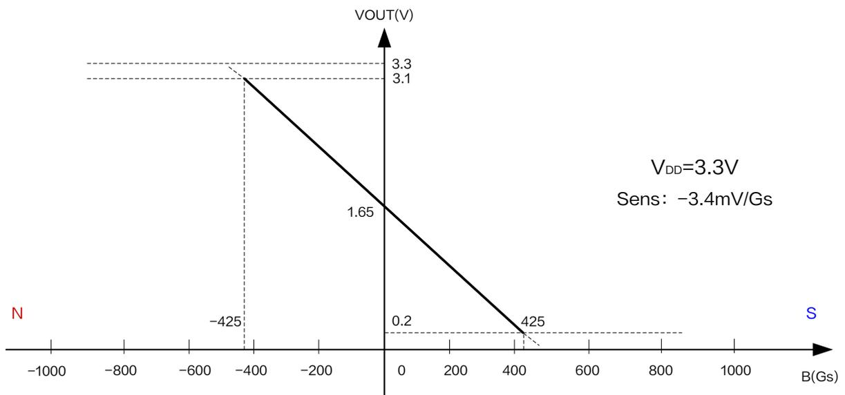
图 5.XL45S 输出特性曲线 ( $V_{DD} = 3.3\text{V}$ )
