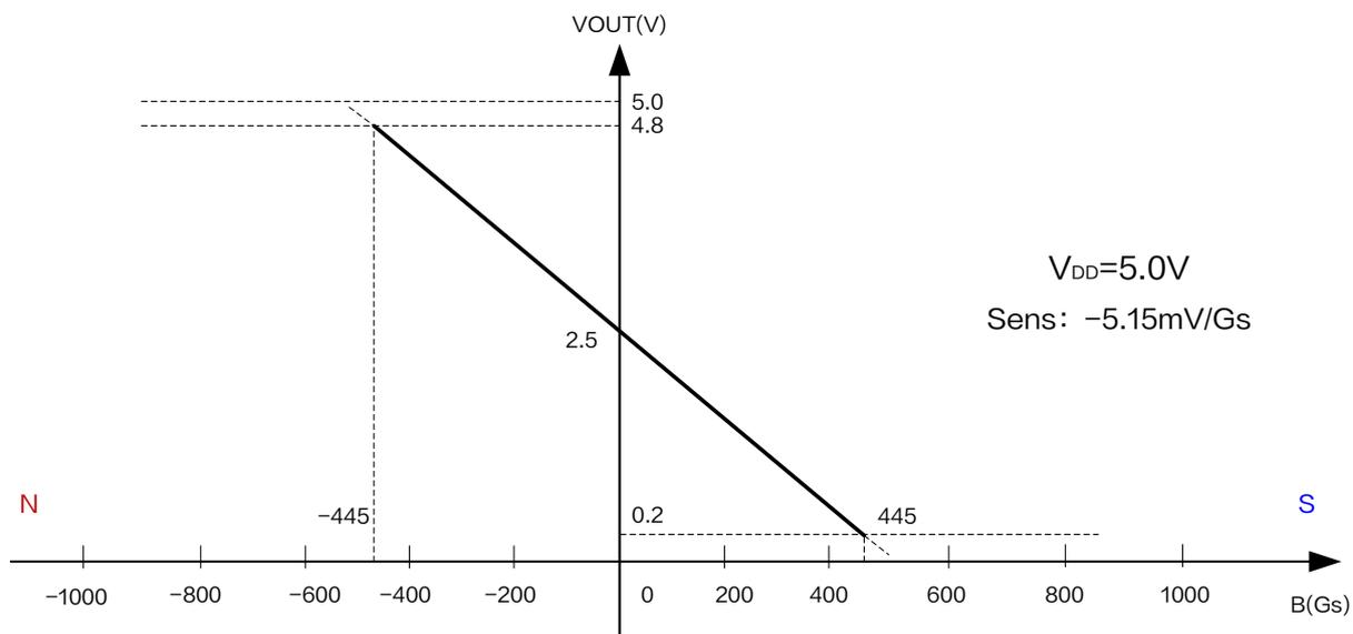
图 6.XL45S 输出特性曲线 (  $V_{DD} = 5.0V$  )
