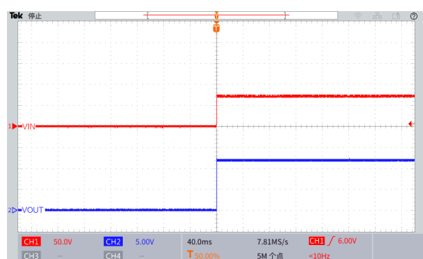
图 19.上电波形图 ( V_{IN}=72V , V_{OUT}=12V , I_{OUT}=0.1A )
