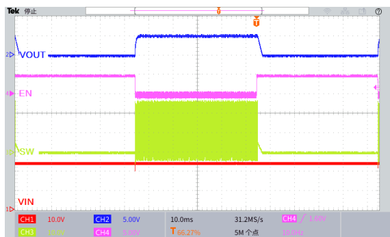
图 36.EN 引脚开关机波形 ( V_{IN}=24V , V_{OUT}=5.0V , I_{OUT}=0.5A )
