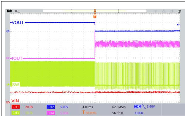
图 26.输出短路波形
