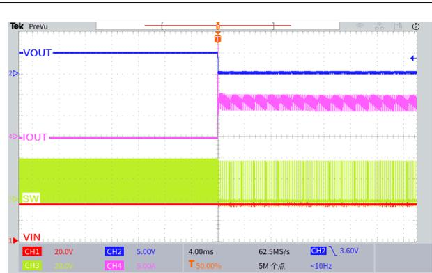
图 27.输出短路波形
