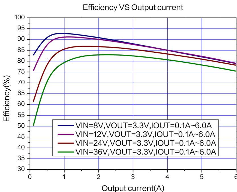
图 5. XL9028 系统效率曲线 (  $V_{OUT}=3.3V$  )
