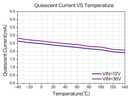
图 15. 静态电流温度系数曲线图
