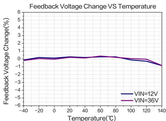
图 14. 反馈电压温度系数曲线图
