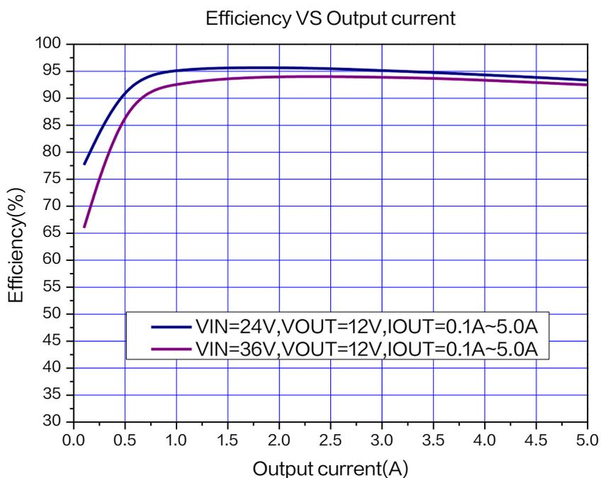
图 9. XL9028 系统效率曲线 (  $V_{OUT}=12V$  )
