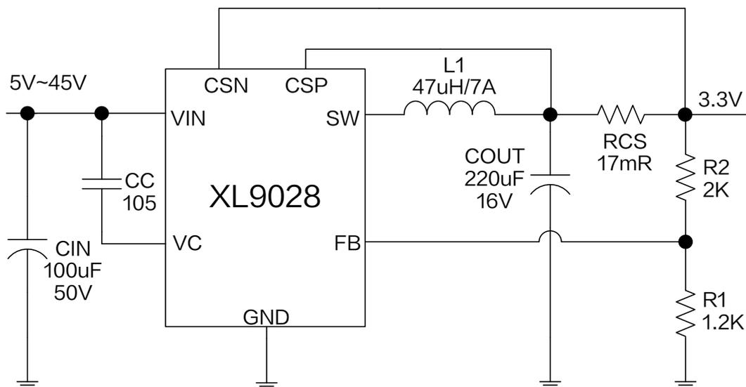
图 4. XL9028 系统参数测量电路 (  $V_{IN}=5V\sim45V, V_{OUT}=3.3V, I_{OUT}=0\sim6A$  )
