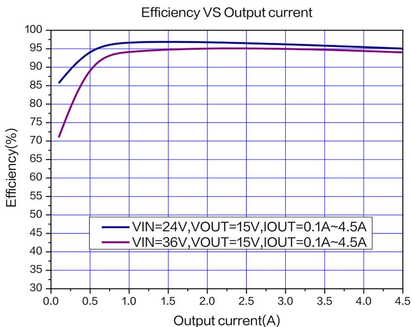
图 11. XL9028 系统效率曲线 ( $V_{OUT}=15V$ )
