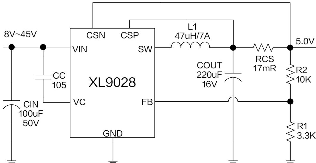
图 6. XL9028 系统参数测量电路 (  $V_{IN}=8V\sim45V, V_{OUT}=5.0V, I_{OUT}=0\sim6A$  )
