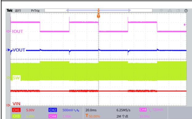
图 28.瞬态负载响应波形
