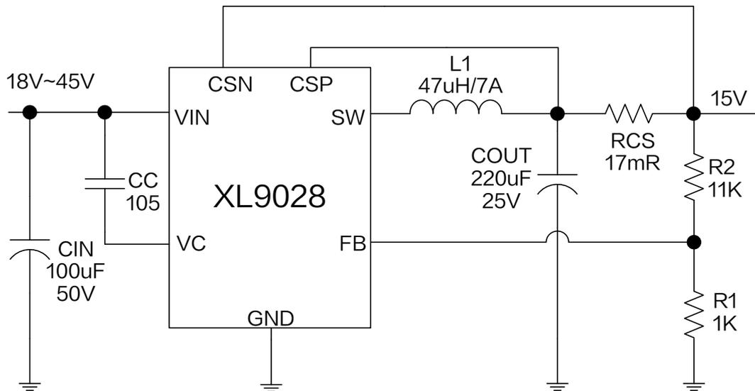
图 10. XL9028 系统参数测量电路 ( $V_{IN}=18V\sim 45V, V_{OUT}=15V, I_{OUT}=0\sim 4.5A$ )
