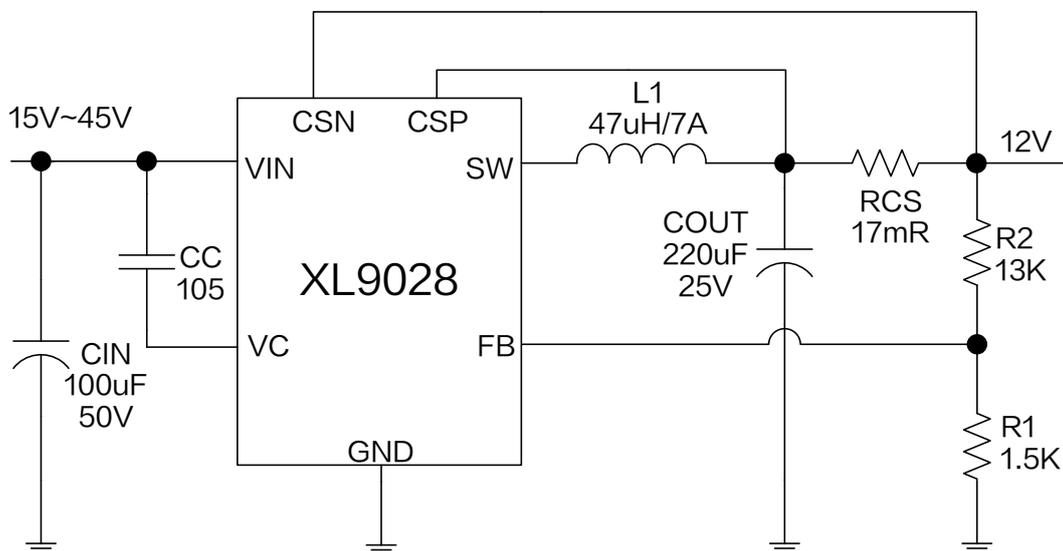
图 8. XL9028 系统参数测量电路 (  $V_{IN}=15V\sim 45V, V_{OUT}=12V, I_{OUT}=0\sim 5A$  )
