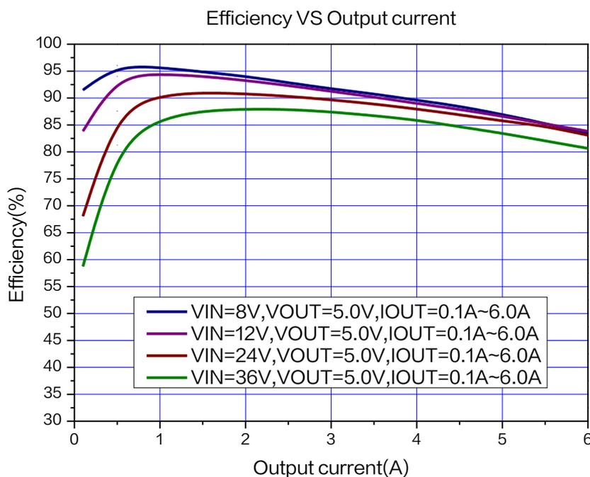
图 7. XL9028 系统效率曲线 (  $V_{OUT}=5.0V$  )
