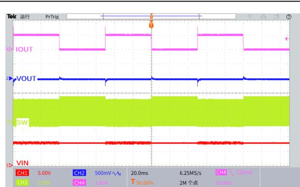
图 29.瞬态负载响应波形
