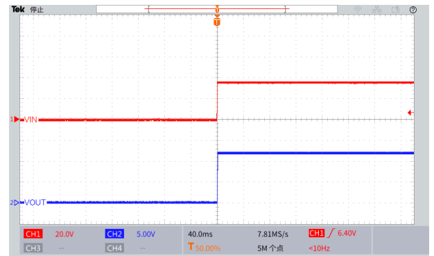
上电波形图 ( V_{IN}=36V , V_{OUT}=12V , I_{OUT}=0.1A )
