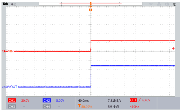
上电波形图 ( V_{IN}=24V , V_{OUT}=12V , I_{OUT}=0.1A )
