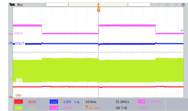
瞬态负载响应波形 ( V_{IN}=24V , V_{OUT}=12V , I_{OUT}=0.1 至 1.0A )
