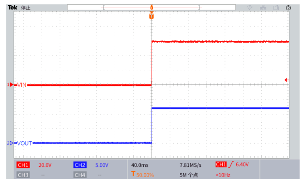
上电波形图 ( V_{IN}=60V , V_{OUT}=12V , I_{OUT}=0.1A )
