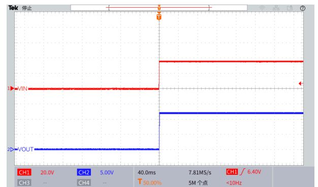
上电波形图 ( V_{IN}=36V , V_{OUT}=12V , I_{OUT}=0.1A )
