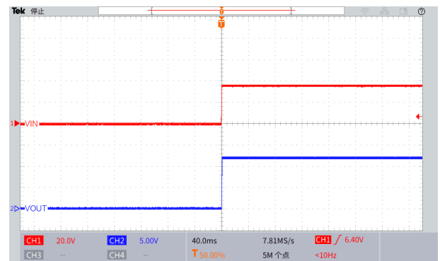
上电波形图 ( V_{IN}=36V , V_{OUT}=12V , I_{OUT}=0.1A )
