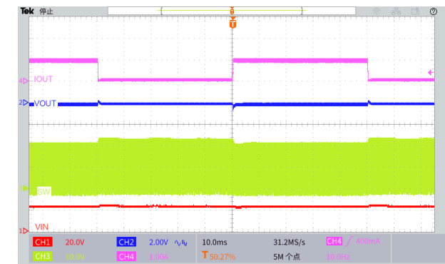
瞬态负载响应波形 ( V_{IN}=24V , V_{OUT}=12V , I_{OUT}=0.1 至 1.0A )
