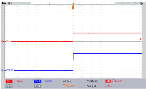
上电波形图 ( V_{IN}=24V , V_{OUT}=12V , I_{OUT}=0.1A )
