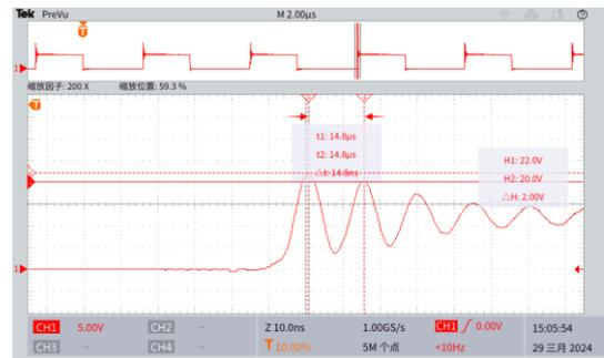
图 7.缓冲位置放置 100pF 电容后开关上升沿波形
