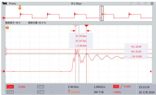
图 8.添加 2.2nF，4mΩ 的 RC 后开关上升沿波形
