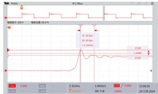
图 9.添加 2.2nF，10Ω 的 RC 后开关上升沿波形
